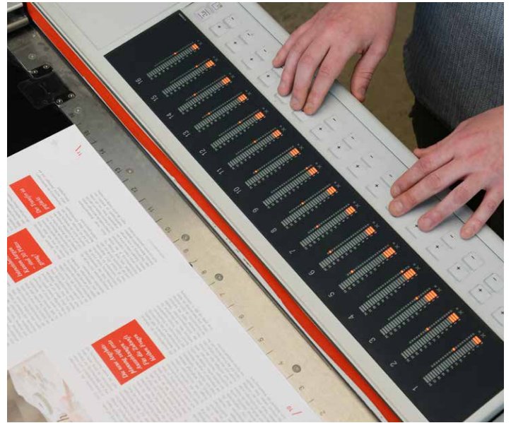
Elektronisches Leitpult der Offsetdruckmaschine zur Regulierung der Farben
